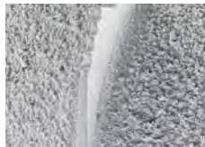
Makrostrukturierte Pfannenoberfläche durch Titanplasma-Beschichtung
