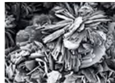
Mikrokristalline bioaktive Calciumphosphat-Beschichtung BONIT
