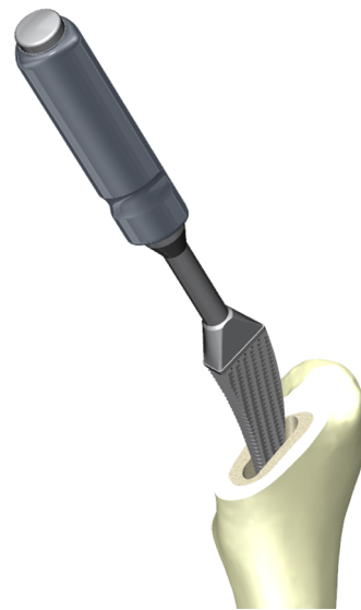
Abbildung 4: Eröffnung des Markraums mit Hohlraummeißel
