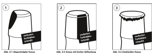
Abb. II.1 Abgeschädigter Konus, Abb. II.2 Konus mit breiter Abflachung, Abb. II.3 Zerkleinertter Konus
