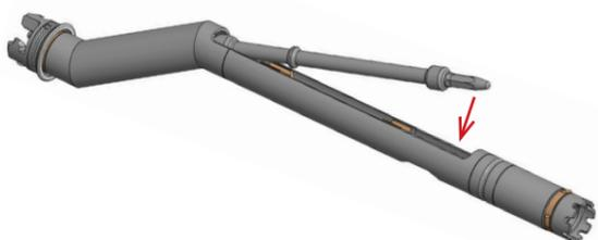
Lassen Sie den Innenantrieb in die Lagerung einrasten
