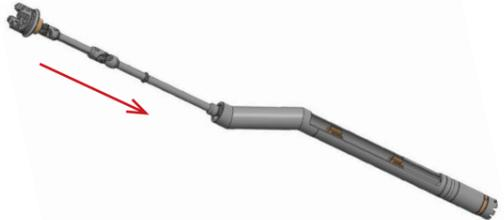
Platzieren Sie den Innenantrieb im Gehäuse
